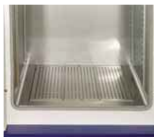
Камера сушильного шкафа с конвекционными отверстиями.
