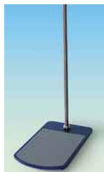
Штатив ST110 стойка Ф16 * h800мм, основание 20*35 см
