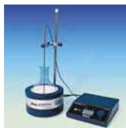
Колбонагреватель в комплекте с термодатчиком и цифровым блоком управления
