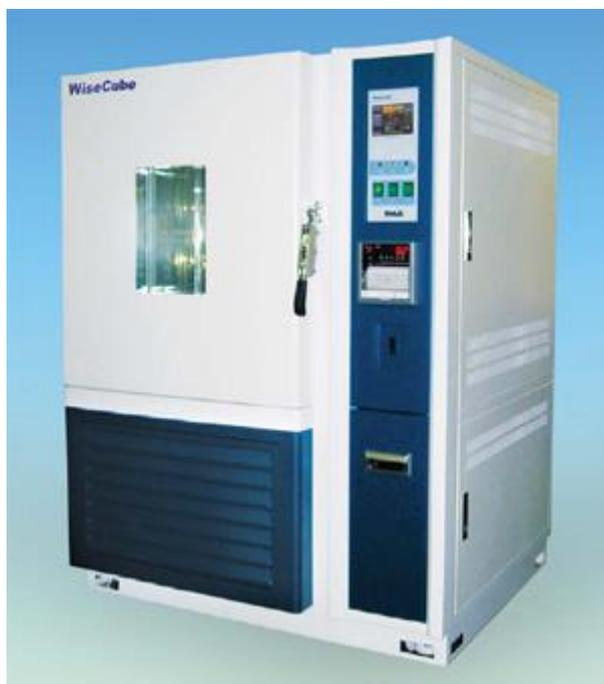
Климатическая камера (термокамера), -20...+80°C, 30-95%, 420 л
