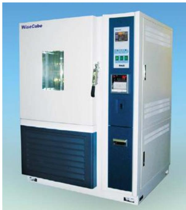
Климатическая камера с расширенным программированием, -20...+80°C, 30-95%, 305 л
